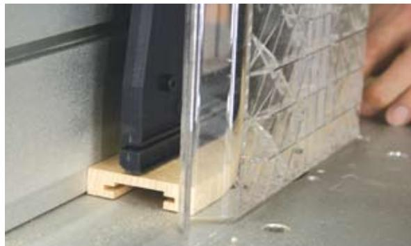
Mit dem speziellen Laminatfräser von Festool (Art.-Nr. 491063) fräsen Sie gleichzeitig zwei 2,8 mm breite und 6 mm tiefe Nuten senkrecht in die zuvor gefräste Nut ein. Jetzt erklärt sich auch die Breite der vorherigen Nut von 28 mm, denn der Laminatfräser muss mit seinem Anlaufring in diese hineinpassen. Stellen Sie den Fräser so ein, dass die beiden Nuten bei 4 mm von der Kante beginnen.
