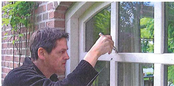
*Indem man mit dem Messstift alle relevanten Punkte am Bauteil markiert, übermitteln der Draht die Maße ans Gerät. Dort entsteht direkt eine CAD-Zeichnung.*
