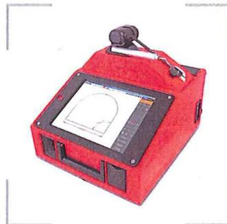
*Der Proliner ist mit einem in jede Richtung drehbaren Messkopf ausgestattet.*
