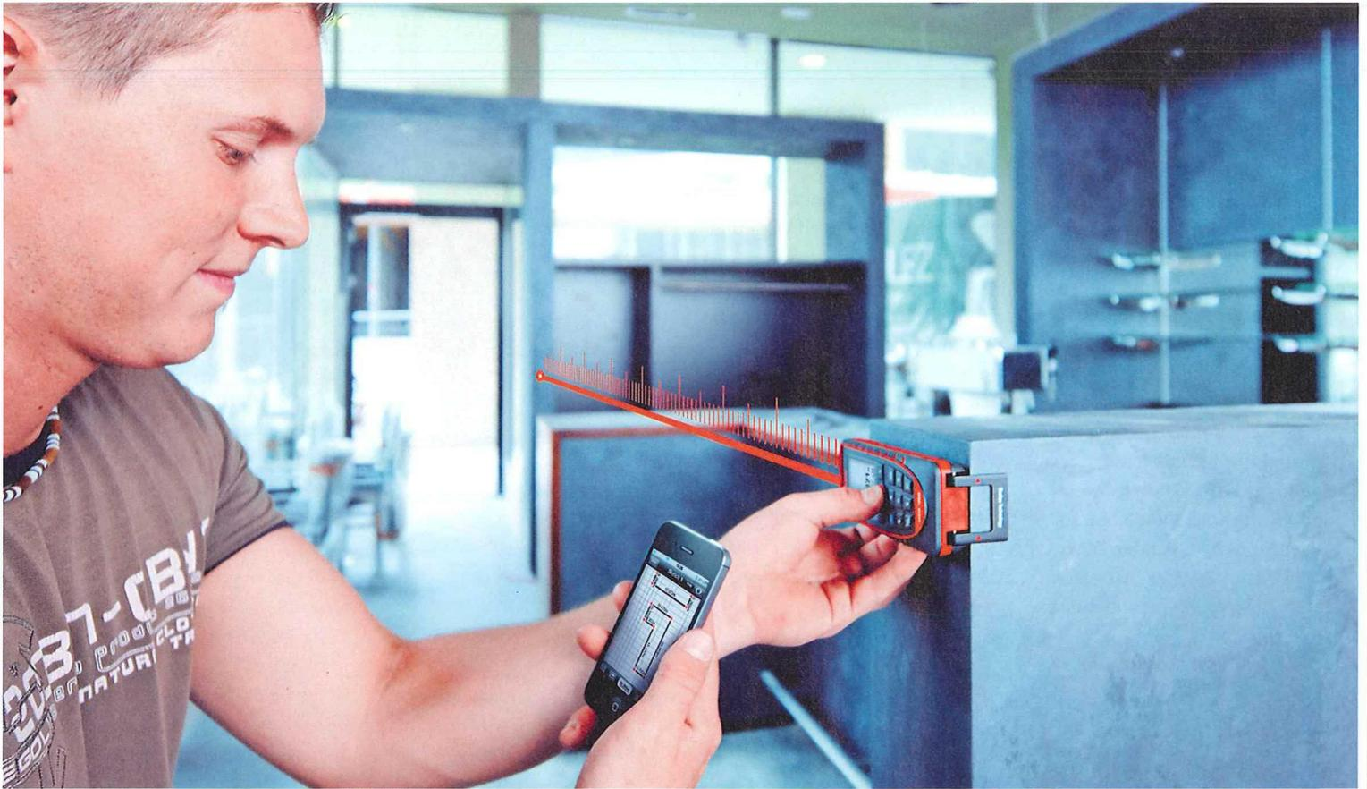
*/ Mehr als messen: Das integrierte Bluetooth Smart übermittelt beim Disto D510 die Messdaten direkt ans iPhone oder iPad. Die kostenlose App „Disto-Sketch“ unterstützt das Erstellen von Grundriss-Skizzen oder Tabellen. Auch Fotos lassen sich schnell bemaßen. (Foto: Leica)*
