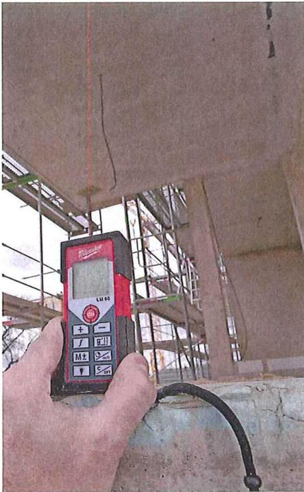
/ Kompaktformat: Mit dem LM60 können Längen von 0,05 bis 60 m mit einer Toleranz von 1,5 mm gemessen werden. (Foto: Milwaukee)
