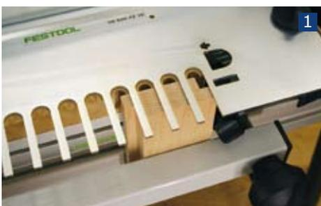
**1.** Vor dem Fräsen, wird das Verbindungssystem, sowie die Oberfräse eingerichtet. Spannen Sie die Werkstücke ein und fräsen Sie mit einem 10mm-Nutfräser die Fingerzinken. Die Frästiefe sollte dabei der Materialstärke zzgl. ca. 1 mm Spielraum entsprechen, damit die Zinken beim Öffnen des Scharniers nicht herauschwenken.
