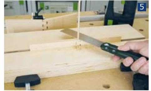
**5.** Setzen Sie eine 5mm Dübelstange als Stift in die Bohrung ein. Damit der Stift nicht heraus fällt, kann an einem der beiden Endzinken ein wenig Leim aufgetragen werden. Kürzen Sie die Dübelstange dann mit Hilfe einer Handsäge (nach Möglichkeit ohne Schränkung). Das Scharnier kann nun von außen sichtbar oder auch von innen mit Spaxschrauben an Ihrem Werkstück befestigt werden. ■
