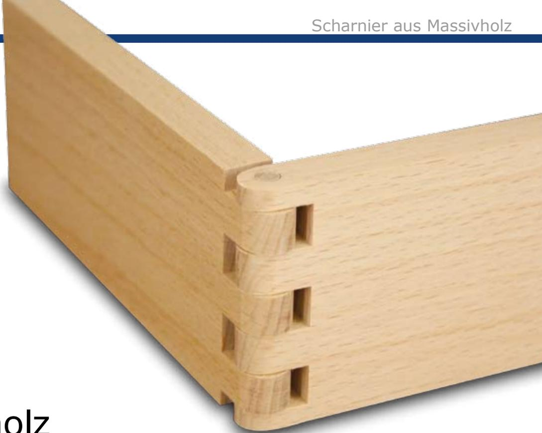
**W**er bei seinem Möbelstück auf metallene Beschläge verzichten möchte, kann mit einfachen Mitteln einen Drehbeschlag aus Massivholz fertigen. Das Paradebeispiel für den Einsatz solcher Massivholzbeschläge ist ein Aktenkoffer, der von Auszubildenden des Tischlereihandwerks hergestellt wird. Der im Folgenden beschriebene Beschlag dient nicht nur als Scharnier
