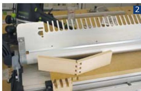
**2.** Prüfen Sie unmittelbar nach den ersten Fräsungen die Gängigkeit der Verbindung. Die Zinkenverbindung sollte leicht ineinander zu stecken sein, damit sich der Beschlag später gut drehen lässt. Gegebenenfalls muss die Verbindung nachgefräst werden.
