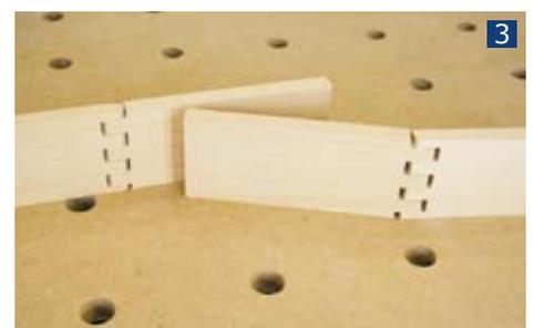
**3.** Runden Sie die Köpfe der Zinkenverbindung entweder an einem Bandschleifer oder von Hand auf einem Schleifpapier ab. Dies ist unbedingt erforderlich, da der Beschlag ansonsten aufgrund der scharfkantigen Ecken nicht drehen würde.
