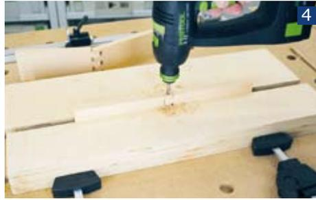
**4.** Bohren Sie ein 5mm-Loch gleichzeitig in beide Teile des Scharniers. Wichtig ist dabei, dass sich die Werkstücke nicht getrennt voneinander bewegen können. Spannen Sie dazu beide Teile des Scharniers zwischen zwei Leisten und bohren Sie das Loch für den Dübelstift. Am besten eignet sich dazu eine Ständerbohrmaschine. Alternativ können Sie die Bohrung auch mit dem Akkuschauber vornehmen. Stellen Sie dabei sicher, dass Sie in beiden Richtungen senkrecht bohren.
