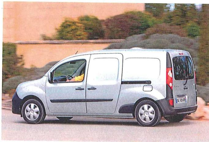
! Gestreckte Version mit langem Radstand: Der Kangoo Maxi verkraftet z. B. hinter der Trennwand statt der üblichen drei einen Kubikmeter mehr an Fracht.
