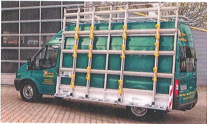
/ Sicherer Glastransport am Ford Transit: Die Sicherheitsspannlatte bietet ein Einspannsystem, das sich schnell auf Ladungen unterschiedlicher Dicke einstellen lässt.
