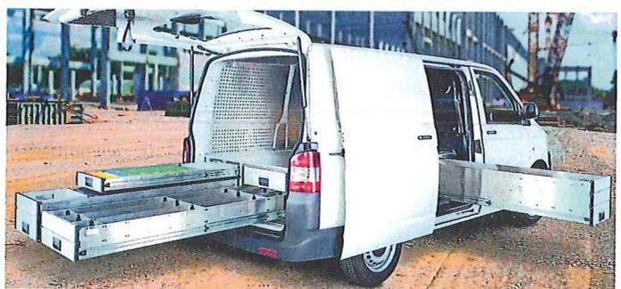
/ Ergonomischer Stauraum: Alle Schubladen am Heck oder der Seitentüre sind zu 100% ausziehbar. Somit kann Be- und Entladen bequem im Stehen erfolgen.
