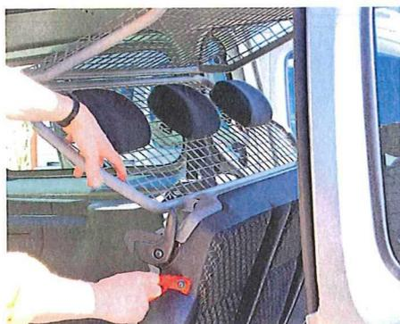
/ Option in manchen Modellen: Beim Umklappen der Rückenlehne entfaltet sich direkt ein Trenngitter.
